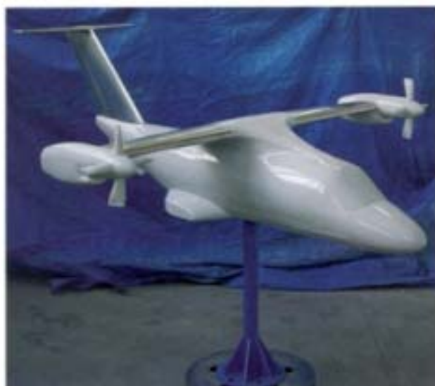
Modello finale in scala 1:8 del prototipo del Convertiplano Europeo realizzato in collaborazione con CRP Technology e i suoi materiali Windform® Wind tunnel final model (1:8 scale) for the prototype of the Tilt Rotor made in collaboration with CRP and its Windform® materials
